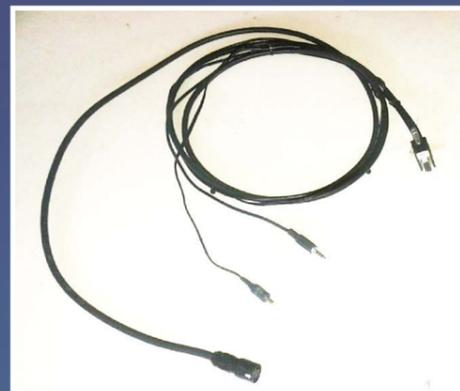
Cable de Conexión cinemómetro cámara
